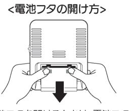
電池フタを開けるときは、電池フタの三部分を押しながら、矢印↓の方向にスライドして下さい。
